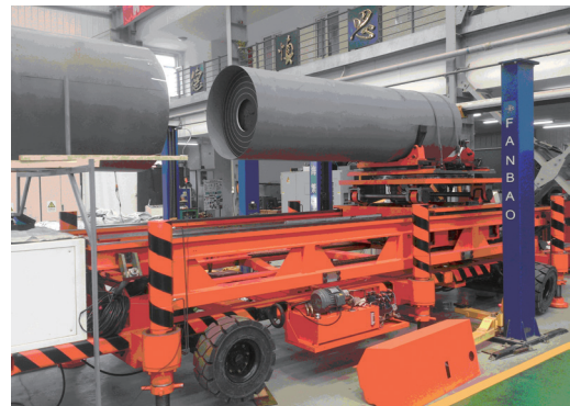
图5 发动机模拟安装试验
